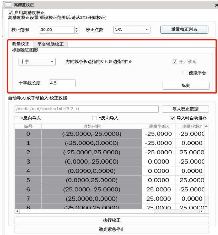
可以根据需求更改校正的图形（十字，整圆，单点）和长度等单位，勾选激光，点击标刻。
