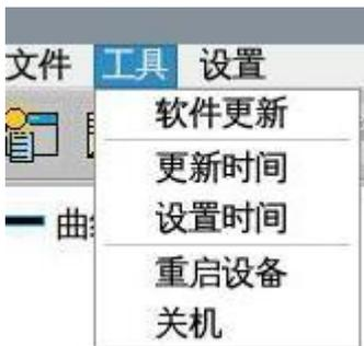
软件更新：当软件需要更新的时候，新增需求的时候，供应商更新完，给到更新文件，拷到 U 盘，将 U 盘插到 USB 口，点击软件更新，然后确认重启设备。
