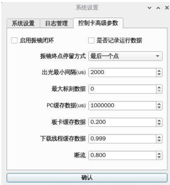
启用闭环振镜：勾选即可启用闭环振镜。
