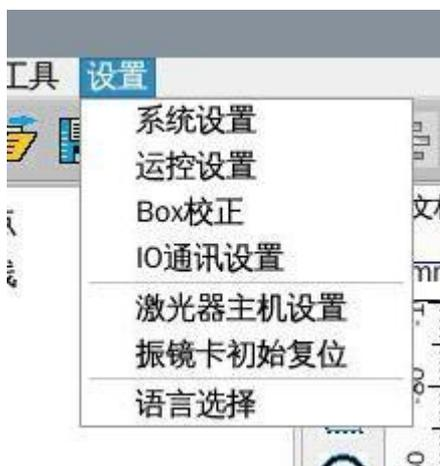
打开激光控制卡设置界面，选择 IO 通讯设置。设置 IO。
