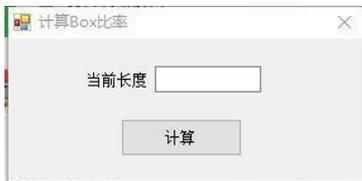
中填入量得的长度，点击“计算”。再点击“激光测试”进行重复测试，直到量得的长度与设置的“测试矩形大小”长度相等为止；
