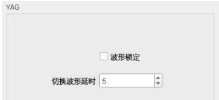
YAG 卡模式：，勾选波形锁定，不可切换波形，波形切换间隔时间（当在工作过程中，需要调用不同波形时，必须设置，不能为 0）开软件远程启动：开软件的时候会给出一个 26 脚的输出信号开软件使能光闸：开软件的时候会给出一个 23 脚的输出信号出激光使能光闸：出激光的时候会给出一个 23 脚的输出信号。
