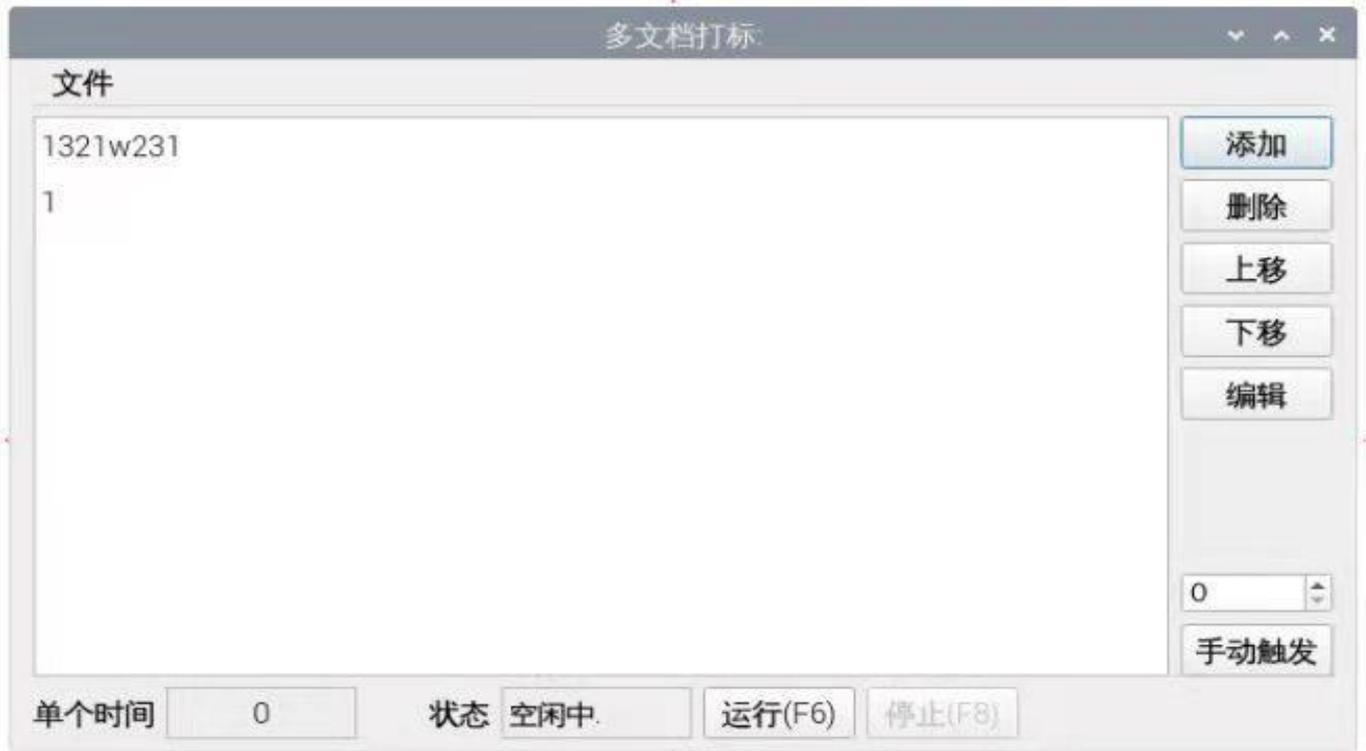
d. 然后在文档后面的下拉框选择创建过的文档，勾选一个 I/O 信号输入，点击确定，然后点击运行或者快捷键按 F6，等待 I/O 触发文档。
