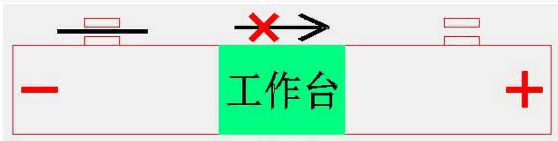
则正负限位方向反了，将板卡上面对应轴的正负限位信号线进行调换，再进行限位方向调试
