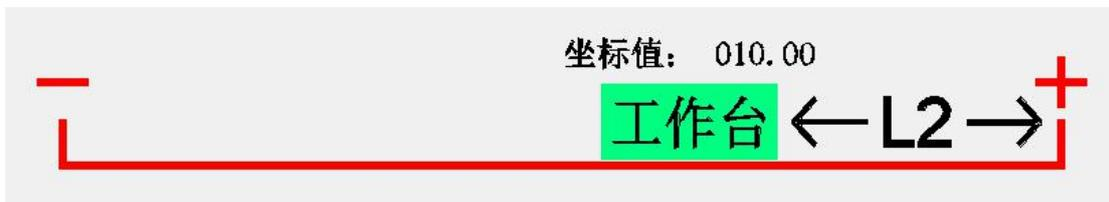
等轴运动到坐标点 10 时，测量并记录工作台到基准点的距离“L2”，再对实际运动距离进行计算： $L = L1 - L2$
