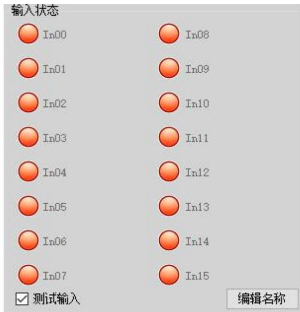
点击输入点位即可进行输入测试（示例）：
