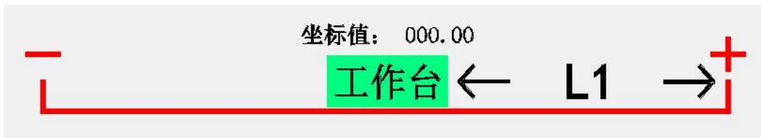
找一个基准点，测量并记录工作台到基准点的距离“L1”，点击
