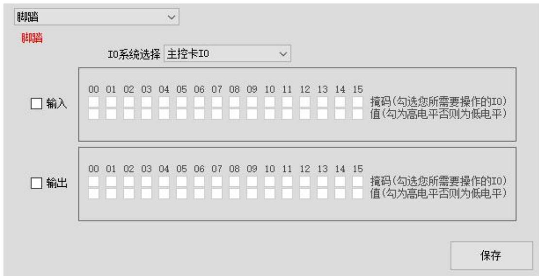
点击 **IO系统选择 主控卡IO**，弹出 IO 系统选择列表：
