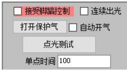
“打开保护气”与  “自动开气”：手动或自动开关保护气
