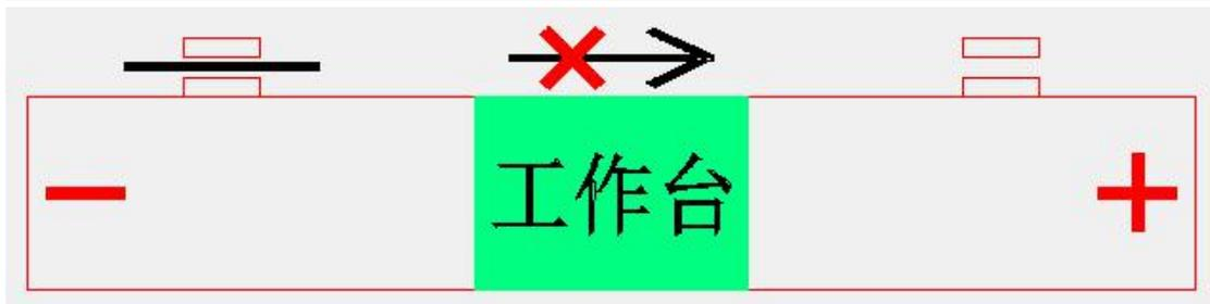
则正负限位方向反了，将板卡上面对应轴的正负限位信号线进行调换，再进行限位方向调试
