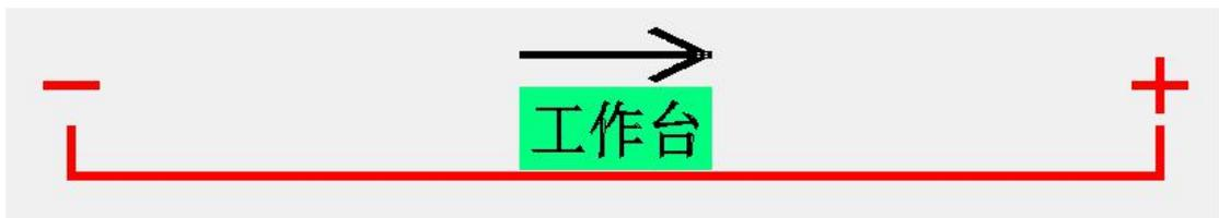
则点动按钮方向反了，在对应的单轴参数界面中勾选  点动按钮方向取反，将点动按钮方向进行取反
