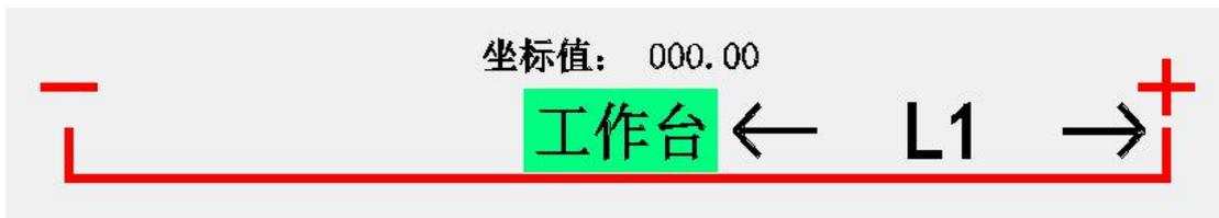
找一个基准点，测量并记录工作台到基准点的距离“L1”，点击
