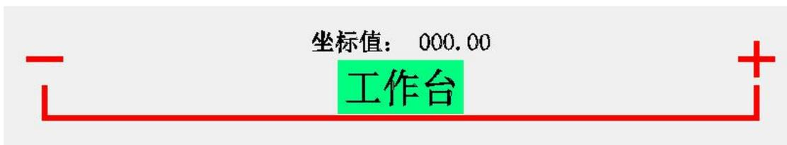
先确定轴的方向（**机械方向**），假设 X0 轴左边为负向、右边为正向
