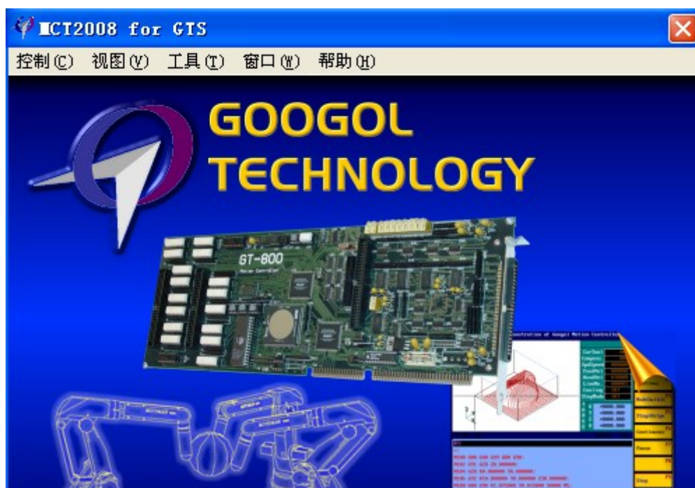
图 2-11 打开 MCT2008 出现此界面表示运动控制器通讯正常
